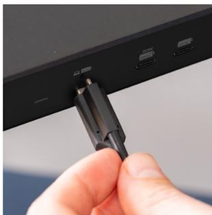
**Mécanisme sécuritaire de connexion**
