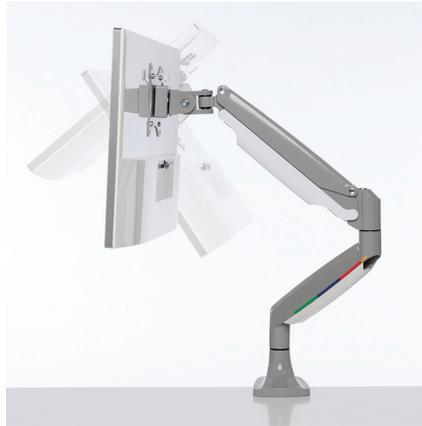
El brazo de monitor SmartFit® con gas comprimido regulable en altura con un toque le ofrece un control total sobre la posición del monitor gracias al fácil ajuste de la altura, la profundidad y el ángulo, con un ajuste de altura de 170 a 505 mm (de 6,7 a 19,9 pulg.), giro y rotación del monitor de  $\pm 90^\circ$  y ajuste de inclinación de  $\pm 90^\circ$ .
