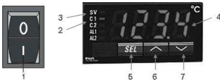
Figura 10: Sección de control de calefactores.
