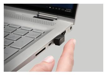
Moderne Fingerabdruck-Technologie vereint höchste biometrische Leistung und 360°-Lesbarkeit mit Antispoofing-Schutz und übertrifft Branchenstandards für die Falsch-Zurückweisungsrate "False Rejection Rate" (FRR 3%) und Falsch-Akzeptanzrate "False Acceptance Rate" (FAR 0,002%).
