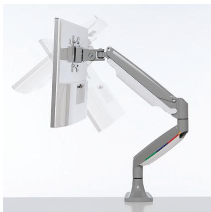
Il braccio per monitor one-touch con molla a gas **integrata** offre controllo completo sulla posizione del monitor mediante una facile regolazione di altezza, profondità e angolazione, con regolazione dell'altezza da 170 mm a 505 mm, rotazione del monitor di +/-90° e regolazione dell'inclinazione di +/-90°.
