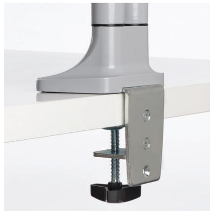
Einfache, nicht permanente Installation durch C-Klemme (Tischplattenstärke 10 - 85mm) oder Tülle (Tischplattenstärke 10mm - 80mm, Tüllenlochdurchmesser 10,5 - 50mm). Die Installation ist nicht dauerhaft und hinterlässt keine Spuren. Ein Werkzeugsatz zur einfachen Entfernung ist im Lieferumfang enthalten.
