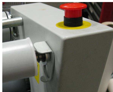
Figura 12: Leva de bloqueo bajada
