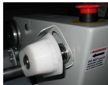
Figura 15: Posizione di carico svolgitore.
