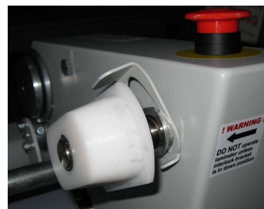
Figure 15 : Position de chargement de déroulement
