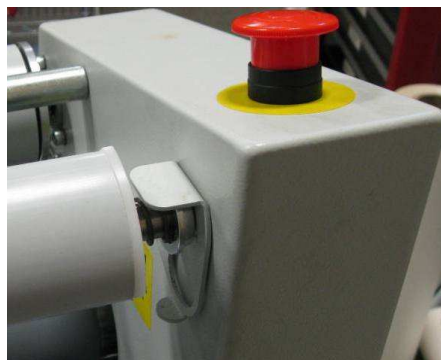
Figura 12: Interblocco in basso
